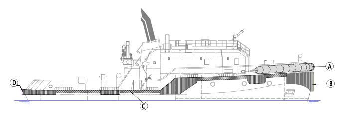
拖轮护舷的工作环境比较恶 劣,多数拖轮装有多种护舷,以 适应不同工作环境的需求。
